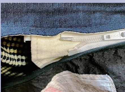
ファスナー損傷
