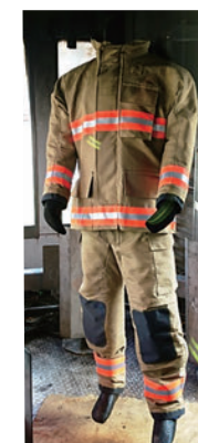
8 秒間火炎曝露し 2～3 度火傷を測定
