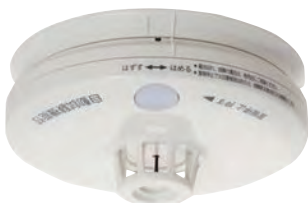
煙式 住宅用火災警報器 NEW 火災をいち早く見つけて音声でお知らせする煙式の住宅用火災警報器です。 TG70097 ¥3,500 (税込¥3,850) 感知方式：煙感知式(光電式) 対象火災：住居火災(居室、階段、廊下等に設置) 電源：専用リチウム電池 外形寸法：φ98×H41mm 標準付属品： 取付ねじ2本、石膏ボード用ピン5本、専用リチウム電池 ※取付ベース本体付属
